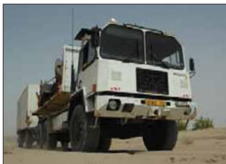
Nord de Moussoro, le 25 avril 2011 - Le camion Saurer 10DM muni d'un plateau escamotable qui assure le transport de la DIGGER D-3.
