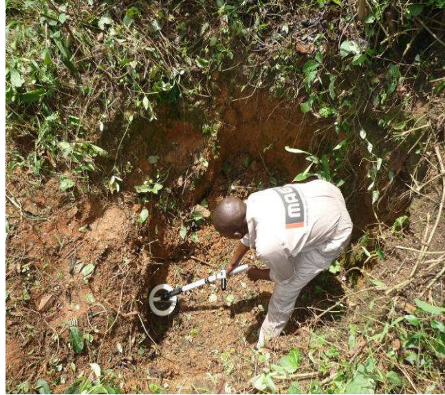
Enquête technique pour localiser un mortier non-explosé suspecté de se trouver sous terre
