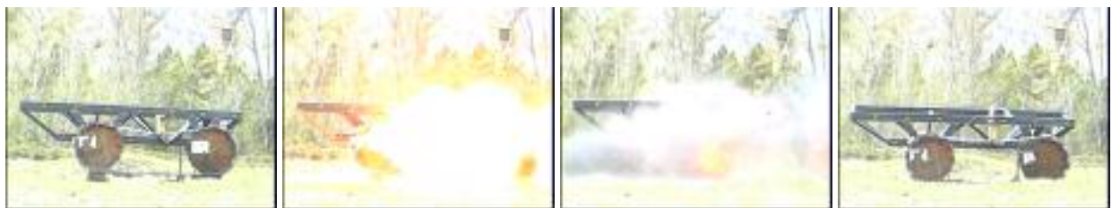
Figure 6. TNT (200g) en contact direct sous la chenille entre les roues.
