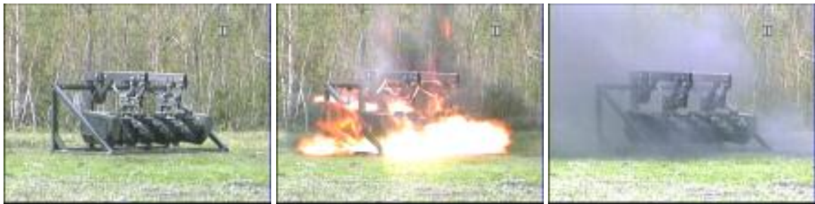
Figure 5. TNT (200g) placé sous l'outil de défrichage (simulation d'une mine à effet de souffle déclenchée par la fraise de débroussaillage)
