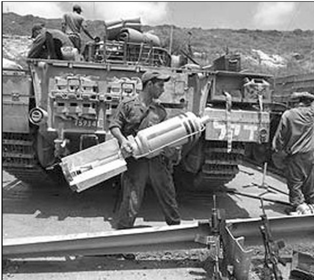
© David Silverman Un soldat israélien charge son tank, transportant un obus capable de transpercer un blindage. On peut observer le dard de l'uranium appauvri sur chaque obus.
