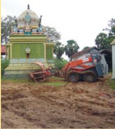
EN HAUT À GAUCHE : Déminage manuel. EN BAS À GAUCHE : Utilisation d'un mini-fléau Bozena pour contrôler la zone autour d'un temple. CI-DESSUS : Une personne de la liaison communautaire effectue une sensibilisation aux dangers des mines.
