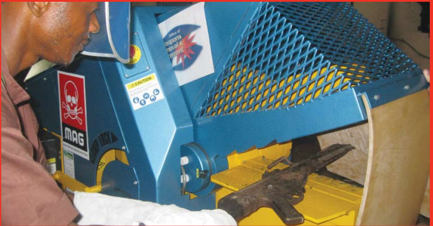
MAG utilise des cisailles hydrauliques pour découper les armes légères.
