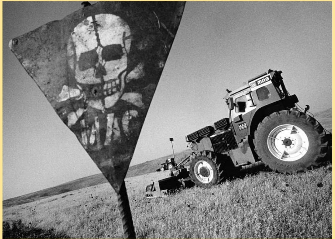
EN HAUT À GAUCHE : Déminage manuel. EN BAS À GAUCHE : Préparation d'une prochaine destruction. CI-DESSUS : Utilisation de tracteurs blindés Armtrak équipés de rouleaux afin de contrôler que la terre est dépolluée.
