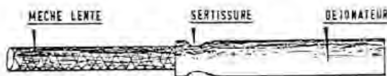
Fig. 7 - Amorçage du détonateur par jonction de la mèche au détonateur
