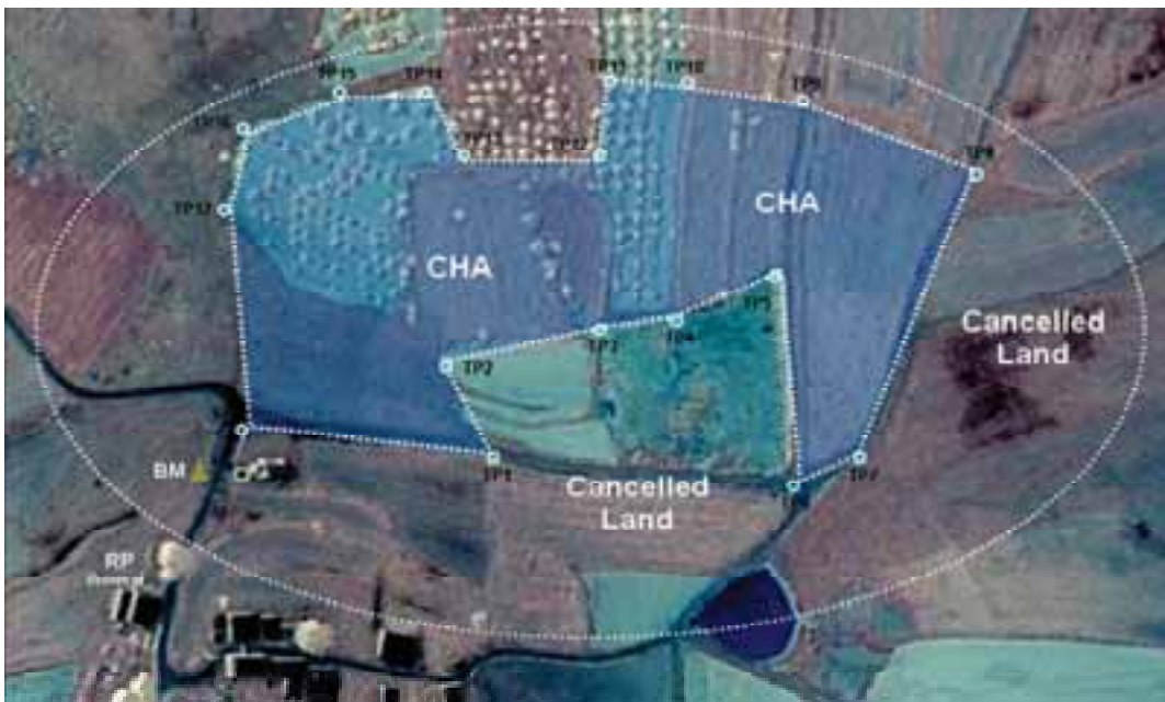
Illustration 2 – Exemple de conclusion initiale sur la base d'une enquête non technique. Sur la base des nouvelles preuves disponibles, la zone à l'extérieur de la ZDC (CHA) a été déclassée ; pour des raisons de cartographie, et non physiquement sur le terrain, la ZDC a été marquée avec un point de référence (RP), un repère de base (BM) et des points d'inflexion (TP).
