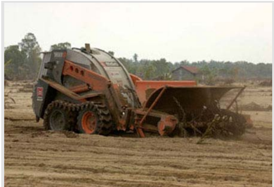
Le « Bozena 4 », machine de déminage à fléaux, peut être contrôlé à une distance d'environ 2 000 mètres.
