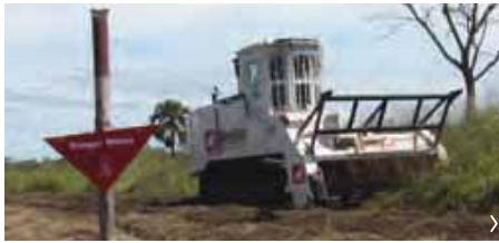
Elimination de mines antichar enterrées de type TM-62 P3 et PT-MI-BA III avec le Mini MineWolf lors d'une série de tests effectués en 2007.
