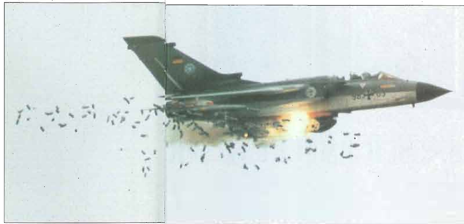
↑ Un avion Tornado, de la Luftwaffe, en train de répandre des sous-munitions. Environ 40% de ces engins n'éclatent pas au moment de l'impact. Ils restent donc actifs sur le terrain et ont des effets semblables aux mines. Cette idée de répandre des «bombettes» par millions sur un pays ou une région ne peut plus être acceptée par l'opinion publique.
