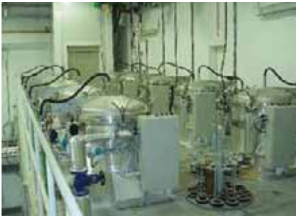
Figure 6.1 : Fusion de TNT en autoclaves dans l'usine de neutralisation des munitions d'Ankara (NAMSA)
