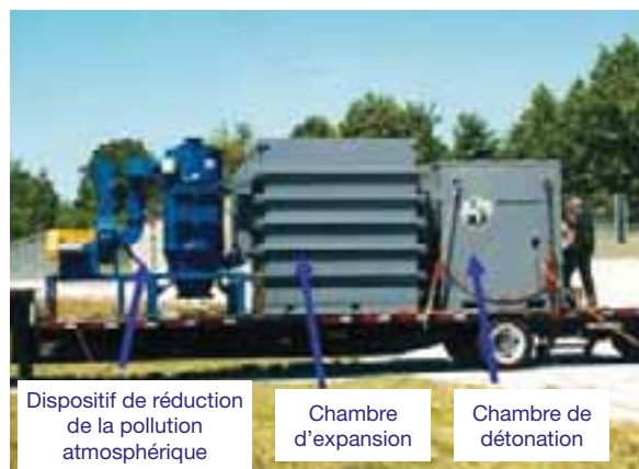
Figure 4.6 : Version mobile d'une chambre de détonation avec système de contrôle de la pollution atmosphérique et de la surpression.
