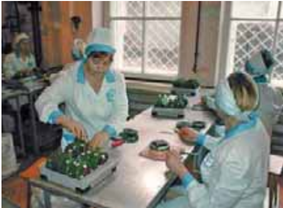
Figure 5.1 : Démontage manuel de mines terrestres antipersonnel (Donetsk, Ukraine)
