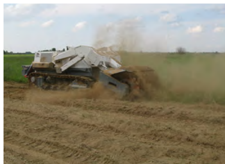
Une DIGGER D-3 en opération de déminage mécanisée.
