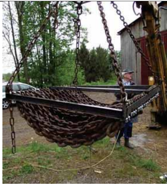
Le dernier arrangement DEMICHAIN, 1 m 2 , 350 kg
