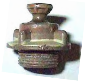
Fig. 5 – Allumeur à pression indétectable Mle 1953 (AL PR ID 53)
