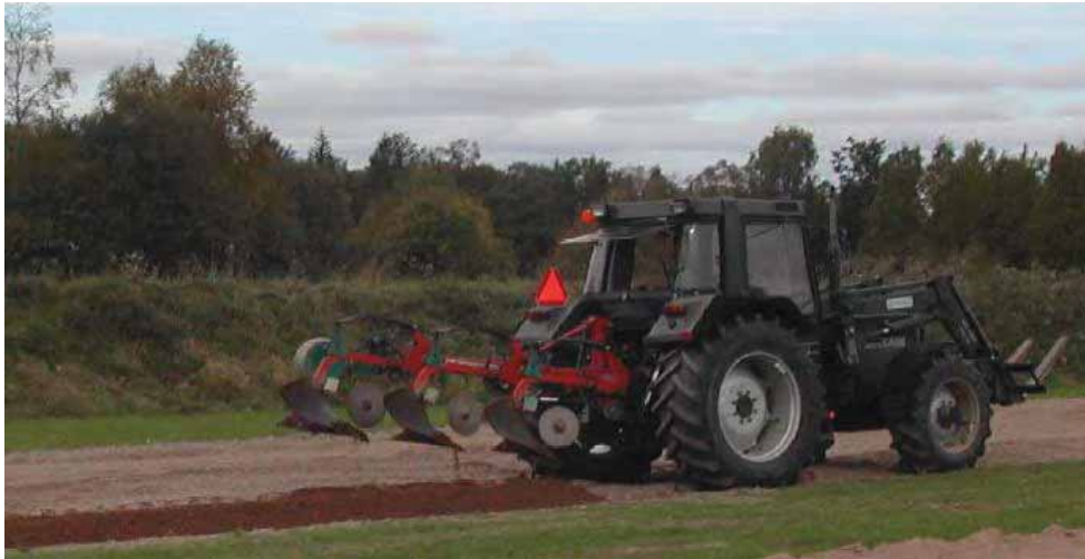
Figure 2 : préparation de couloirs de test standards –décompactage du sol image © SWEDEC
