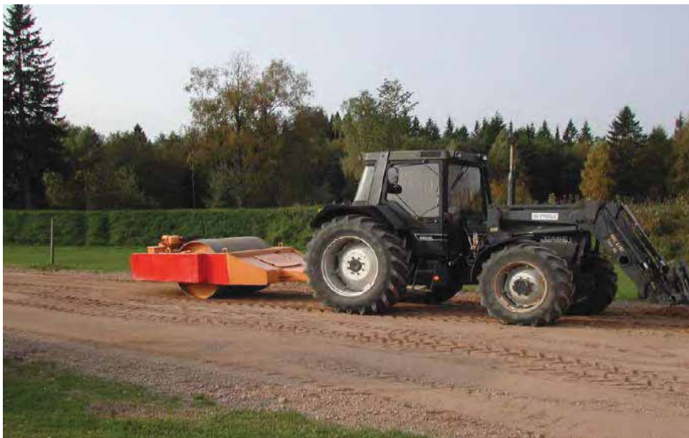
Figure 3 : Préparation des couloirs de test standards – compactage du sol image © SWEDEC
