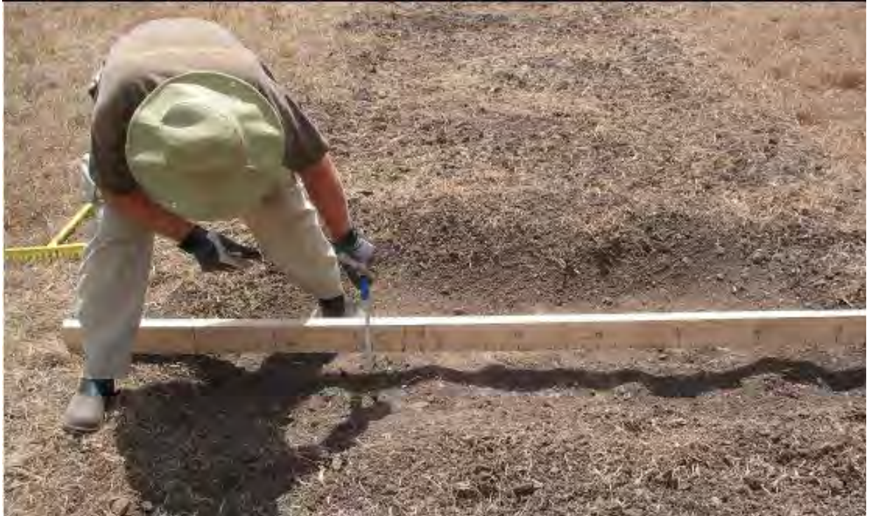
Image 1 : Mesure directe de la profondeur de pénétration
