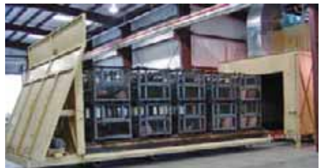
Figure 4.5 : L'installation de décontamination par flux de gaz chaud. L'automotrice est chargée avec des paniers métalliques contenant des munitions prétraitées.
