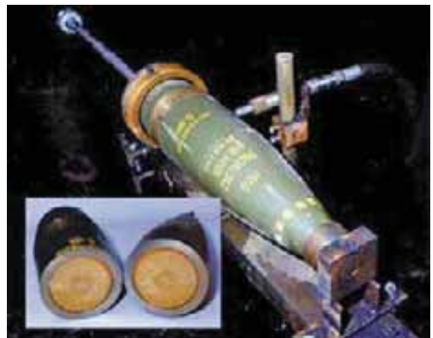
Figure 5.3 : Équipement pour le découpage hydro-abrasif, et coupe d'un obus de 155 mm
