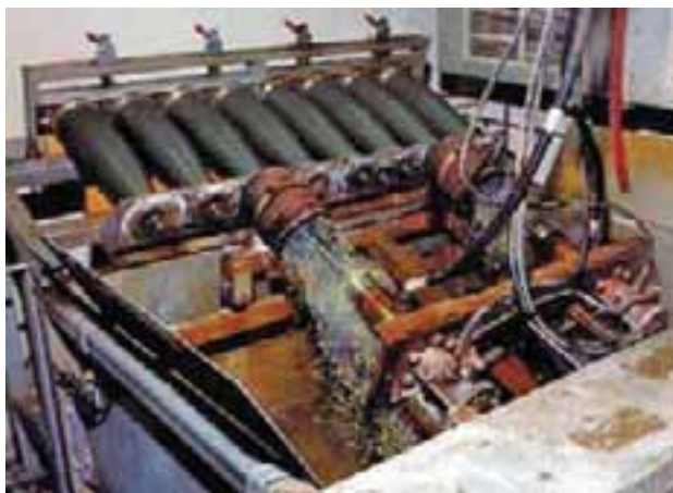
Figure 6.3 : Lavage par jet d'eau d'obus de 155 mm
