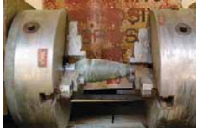
Figure 5.2 : Tour utilisé pour le découpage d'un mortier de 81 mm
